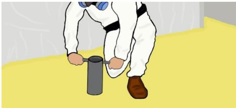
Figure 4 : Prélèvement des éprouvettes par carottage
